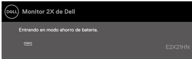
Si el cable VGA, DP o HDMI no está conectado, aparece un cuadro de diálogo flotante como se muestra a continuación El monitor ingresará al modo de ahorro de energía después de 4 minutos si se deja en este estado.
