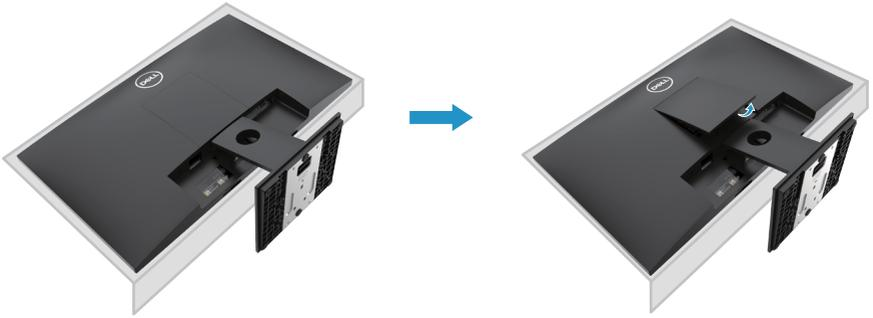
2. a. Use un destornillador largo y delgado para empujar el pestillo de liberación ubicado en un orificio justo encima del soporte.
