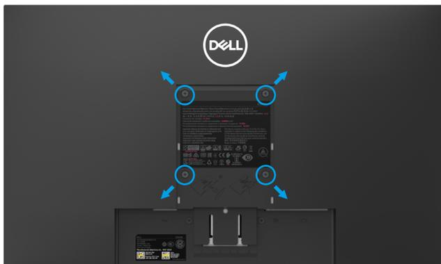
(Dimensión del tornillo: M4 x 10 mm). Consulte las instrucciones que vienen con el kit de montaje de base compatible con VESA.
