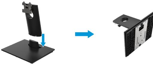
2. Fije el ensamblaje del soporte al monitor.
