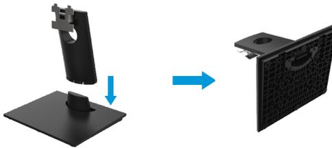
2. Fije el ensamblaje del soporte al monitor.
