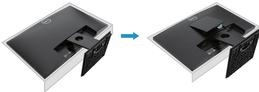
2. a. Use un destornillador largo y delgado para empujar el pestillo de liberación ubicado en un orificio justo encima del soporte.
