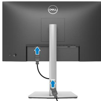
3. Conecte el cable DisplayPort, USB Type-C o HDMI del monitor al ordenador.
