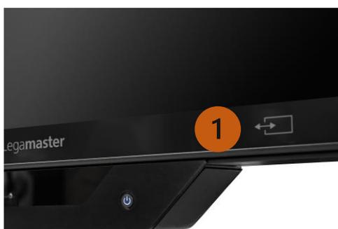
El botón de cambio rápido de fuentes (1) puede ser configurado para intercambiar las dos fuentes de entrada más utilizadas de manera rápida y sencilla
