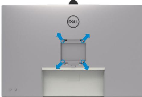
**NOTA:** Utilice tornillos M4 x 10 mm para acoplar el monitor al kit de instalación en pared.
