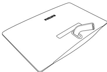
2. Acople el soporte de la base del monitor a la columna base y, a continuación, fije el soporte de la base.
