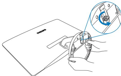
2. Libere el tornillo del soporte de la base y luego saque la base del monitor.
