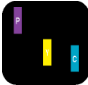
Dos subpíxeles adyacentes: - Rojo + Azul = Púrpura - Rojo + Verde = Amarillo - Verde + Azul = Cian (Celeste)
