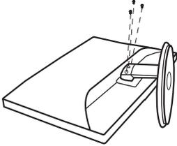
2. Retire los 3 tornillos y, a continuación, la base del monitor:
