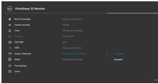
Después de la primera sincronización, la sincronización posterior se basará en los cambios en el grupo predefinido de configuraciones OSD de cualquier nodo de la cadena. Cualquier nodo puede iniciar los cambios de entrada y de salida.
