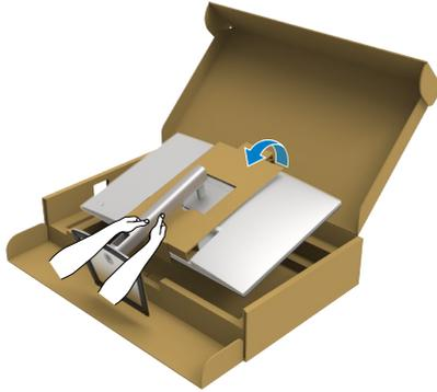
**NOTA:** Agarre el elevador del pedestal firmemente cuando levante el monitor para evitar cualquier daño accidental.
