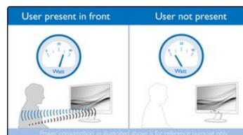
PowerSensor es un "sensor de personas" incorporado que transmite y recibe señales infrarrojas inofensivas para determinar si el usuario está presente y reduce automáticamente el brillo del monitor cuando se ausenta, reduciendo el gasto energético hasta un 80 % y prolongando la vida del monitor.
