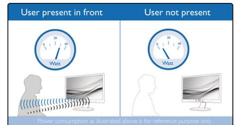
PowerSensor es un 'sensor de personas' incorporado que transmite y recibe señales infrarrojas inofensivas para determinar si el usuario está presente y reduce automáticamente el brillo del monitor cuando se ausenta, reduciendo el gasto energético hasta un 70 % y prolongando la vida del monitor.
