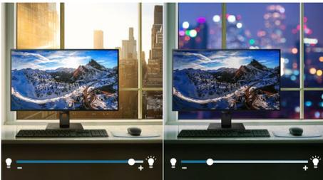
LightSensor utiliza un sensor inteligente para ajustar el brillo de la imagen en función de las condiciones de iluminación de la habitación, para ofrecer una imagen perfecta con un uso de energía mínimo.
